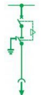
Ilustración 12: Esquema Unifilar Celda de Protección Transformador.
