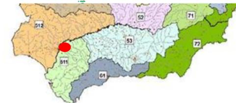
Ilustración 19. Regiones para el coeficiente corrector del umbral de escorrentía. La zona de estudio esta sobre la 511.
