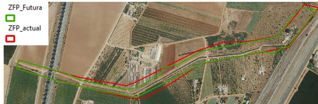
Ilustración 37. Disminución de la zona de flujo preferente con la implementación del encauzamiento.
