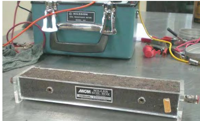
Figura 20. Medida de resistividad en laboratorio.
