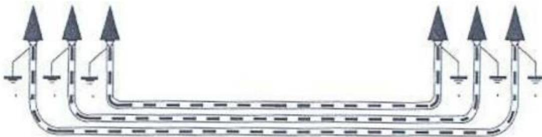
*Figura 23: Puesta a tierra de cubiertas metálicas.*
