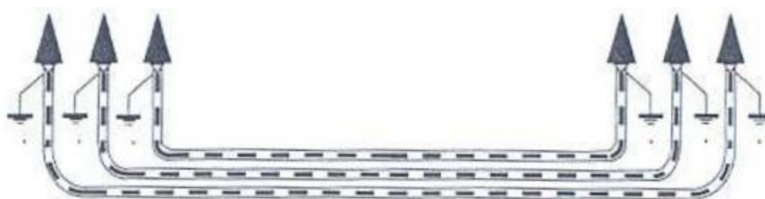
Figura 23: Puesta a tierra de cubiertas metálicas.
