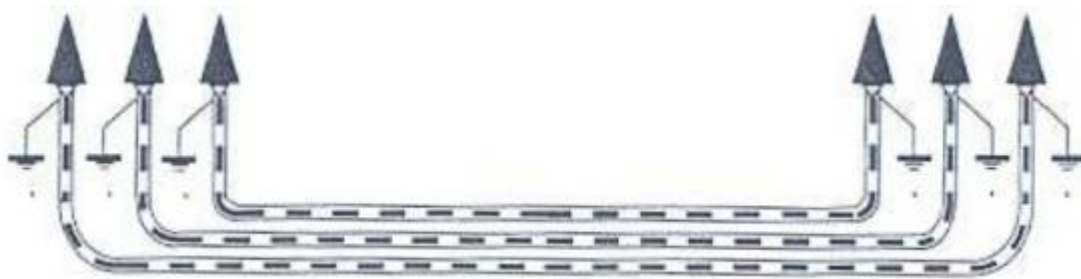
Figura 23: Puesta a tierra de cubiertas metálicas.
