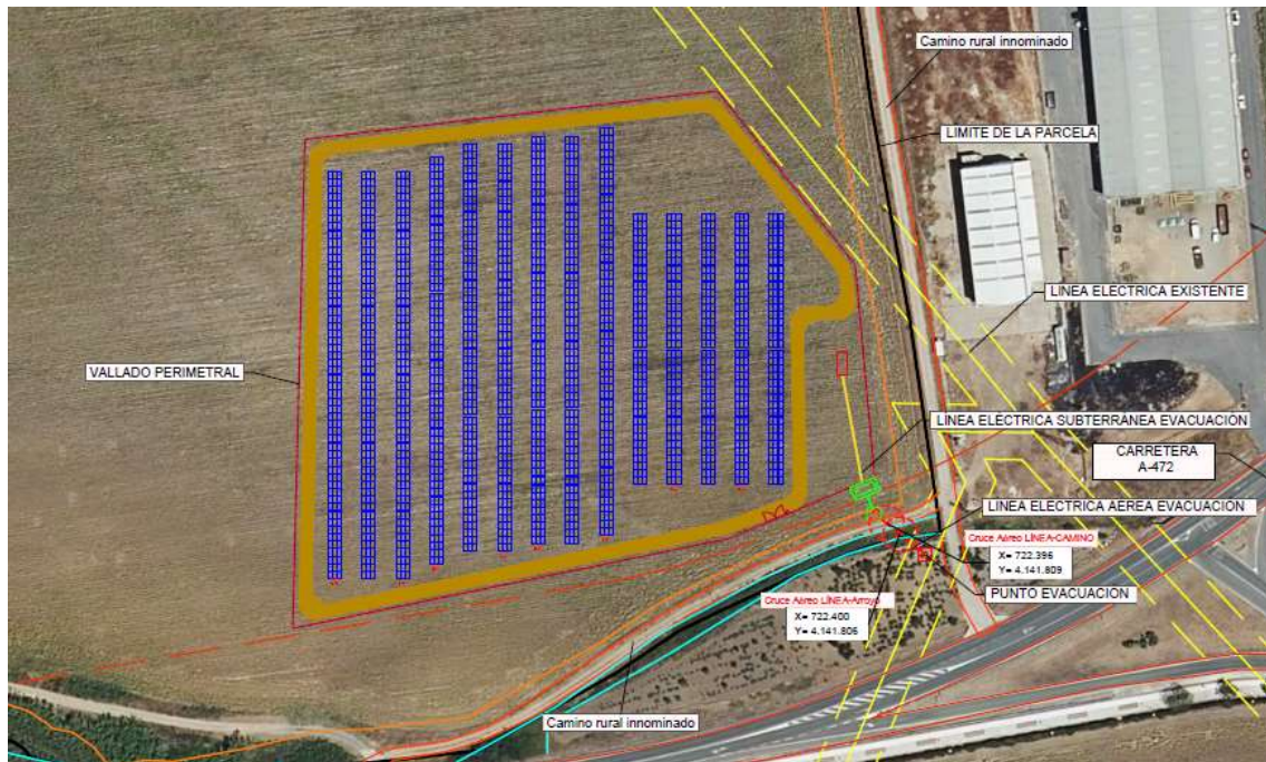
Ilustración 5: Afecciones Línea evacuación
