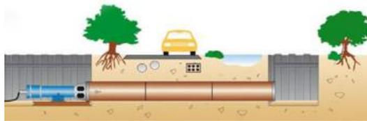
Ilustración 7. Detalle de perforación dirigida en hinca
