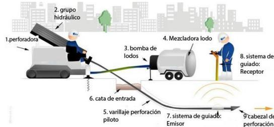
Ilustración 8. Detalle de perforación horizontal dirigida
