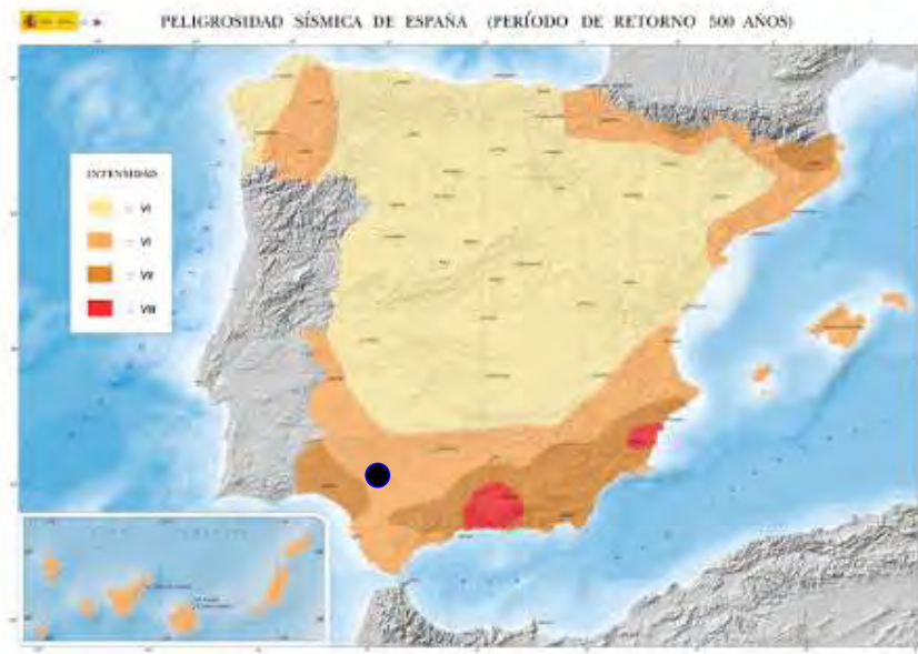
Plano. Peligrosidad Sísmica (intensidades) NCSR-02 (actualizado a 2015)
