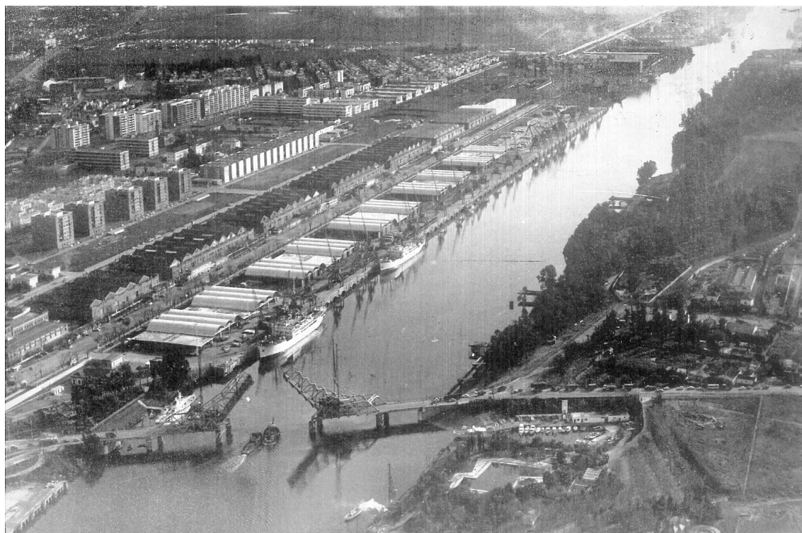
Imagen 43. Estado del muelle de Tablada en 1968, una vez finalizada la ampliación, así como los nuevos grupos de naves, las naves de Frigodocks, y la línea de edificios auxiliares, sólo a falta de la construcción del tinglado 11 para alcanzar el punto de mayor desarrollo del muelle. Aparece consolidado en gran medida el entorno de la avenida Reina Mercedes. Fuente: Memoria anual del Puerto de Sevilla, año 1968, AHPS.
