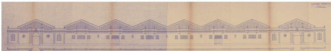
Imagen 34. Alzado de las naves de depósito y almacenes comerciales en la zona complementaria del muelle de tablada, Fernández Casso, 1926. La solución final fue acordada con la dirección de EIA, y se planteaba una mayor economía de medios que la propuesta previa. El plano muestra correcciones, indicando dos accesos por naves intermedias, que se construirían finalmente. Fuente: AHPS.
