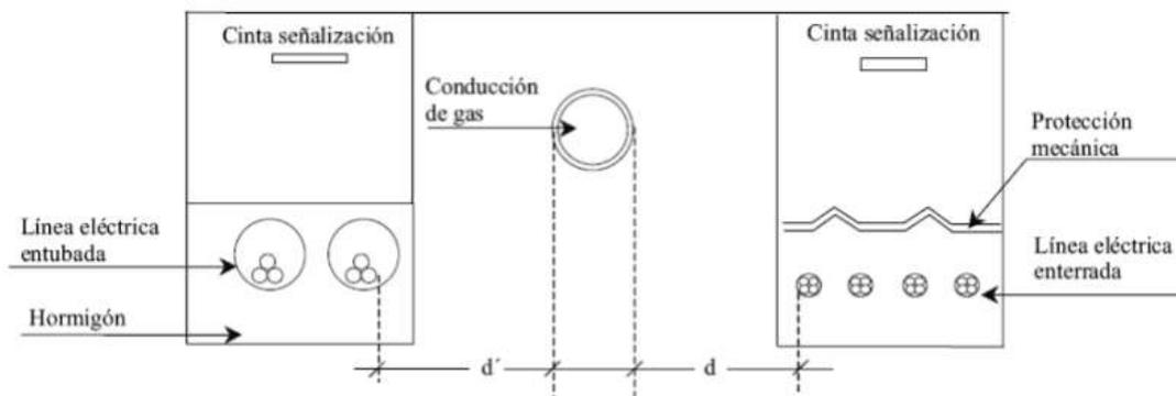
**Figura 30: Detalles de paralelismo y conducciones (ITC-LAT 06).**
