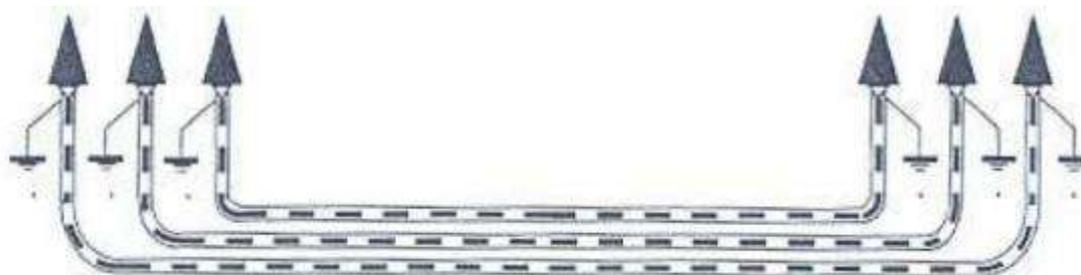
*Figura 26: Puesta a tierra de cubiertas metálicas.*
