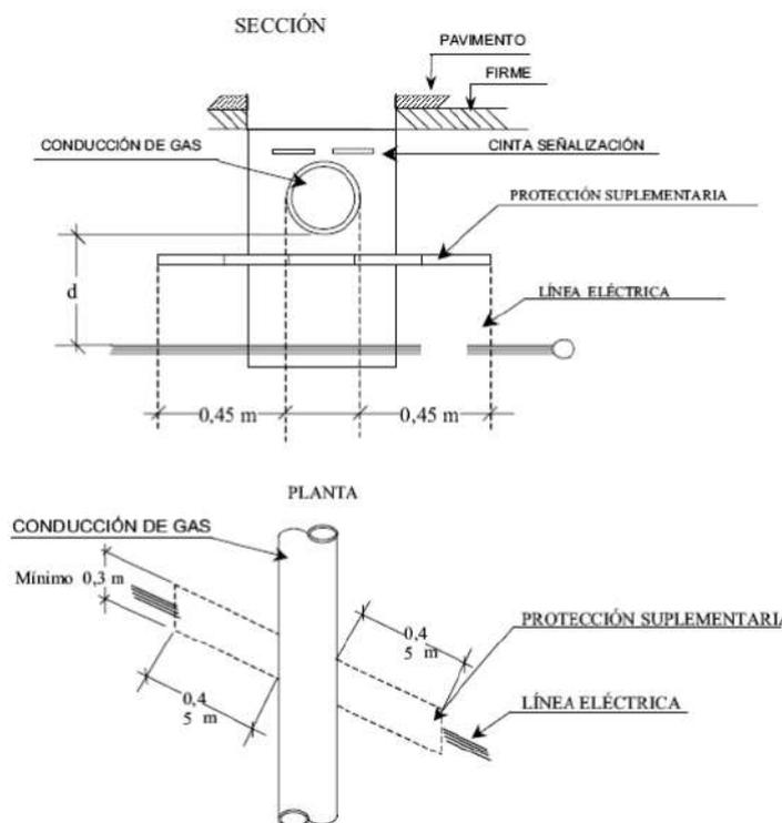
**Figura 28: Detalles de cruzamiento y conducciones (ITC-LAT 06).**
