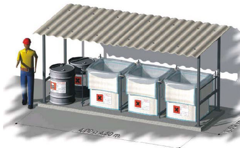
Detalle almacén punto limpio.
