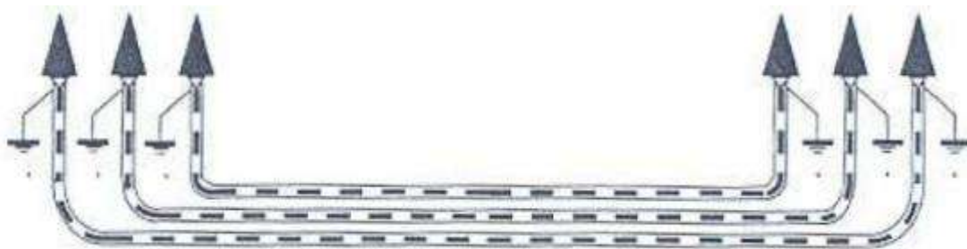
Figura 26: Puesta a tierra de cubiertas metálicas.
