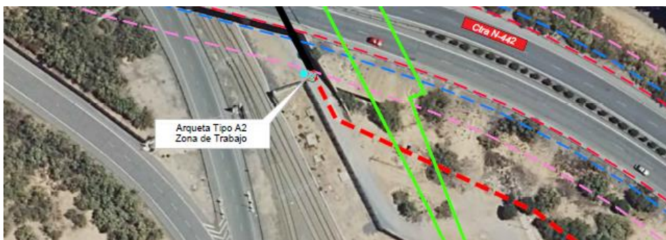
Ilustración 22- Cruce de la línea de evacuación con gaseoducto
