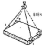
CARGA CON DOS ESLINGAS SIN FIN
