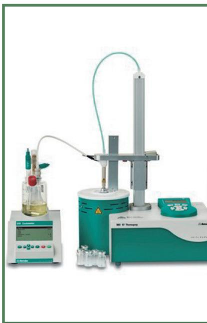
Análisis para la determinación humedad líquido dieléctrico
