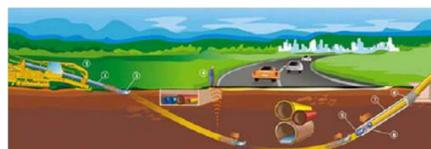
DETALLE DE PERFORACIÓN MEDIANTE TOPO HORIZONTAL EN AUTOVÍA A-48
