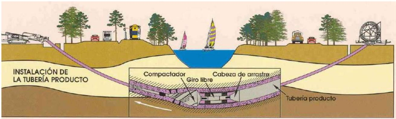
El agujero piloto se perfora desde una plataforma de superficie con un carro inclinado, que se ajusta normalmente en ángulos de 8 a 18 grados sobre la horizontal en la zona de entrada y entre 8 y 12 grados para la salida.
