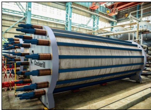
Figura 3-3 - Fotografía de un stack de 5MW de John Cockerill (izda) y esquema de stack de electrolizador de tecnología alcalina (ISE Fraunhofer, 2021)
