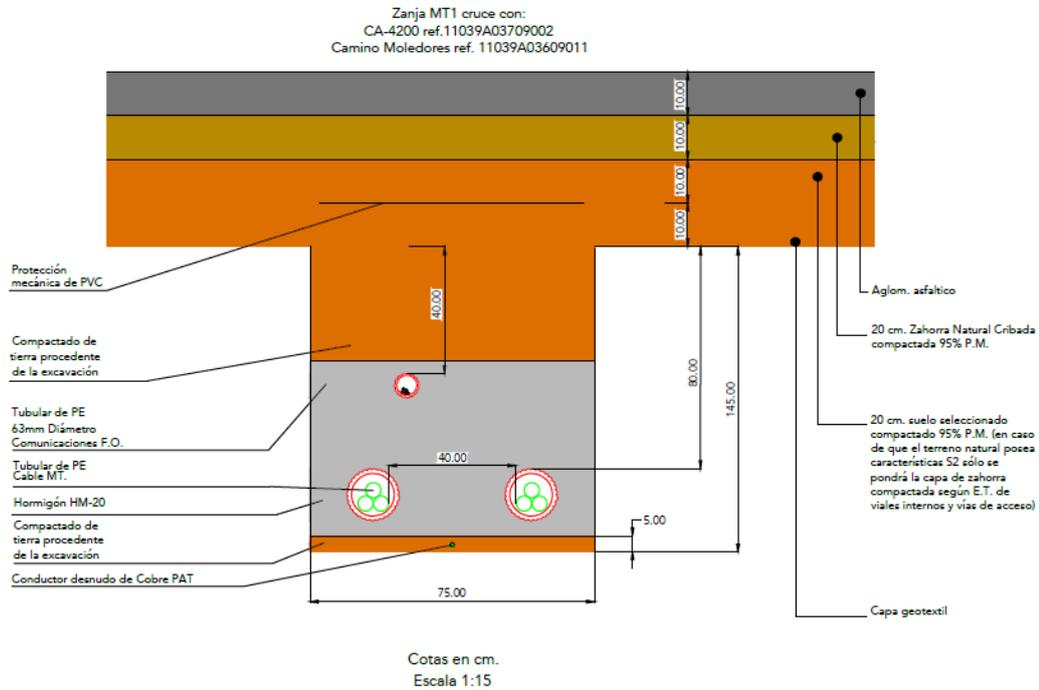
*Ilustración 1.-Disposición de zanja cruce con carretera o cañada*
