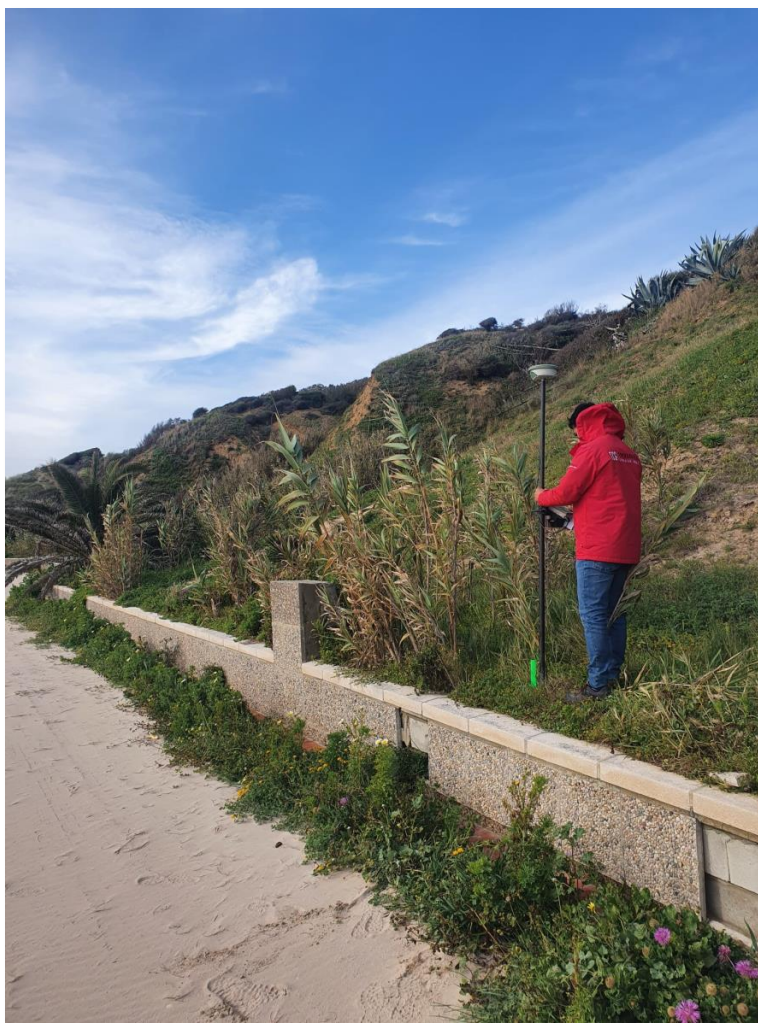
Fig. Nº30 – Levantamiento topográfico de la traza de la red de baja tensión proyectada.
