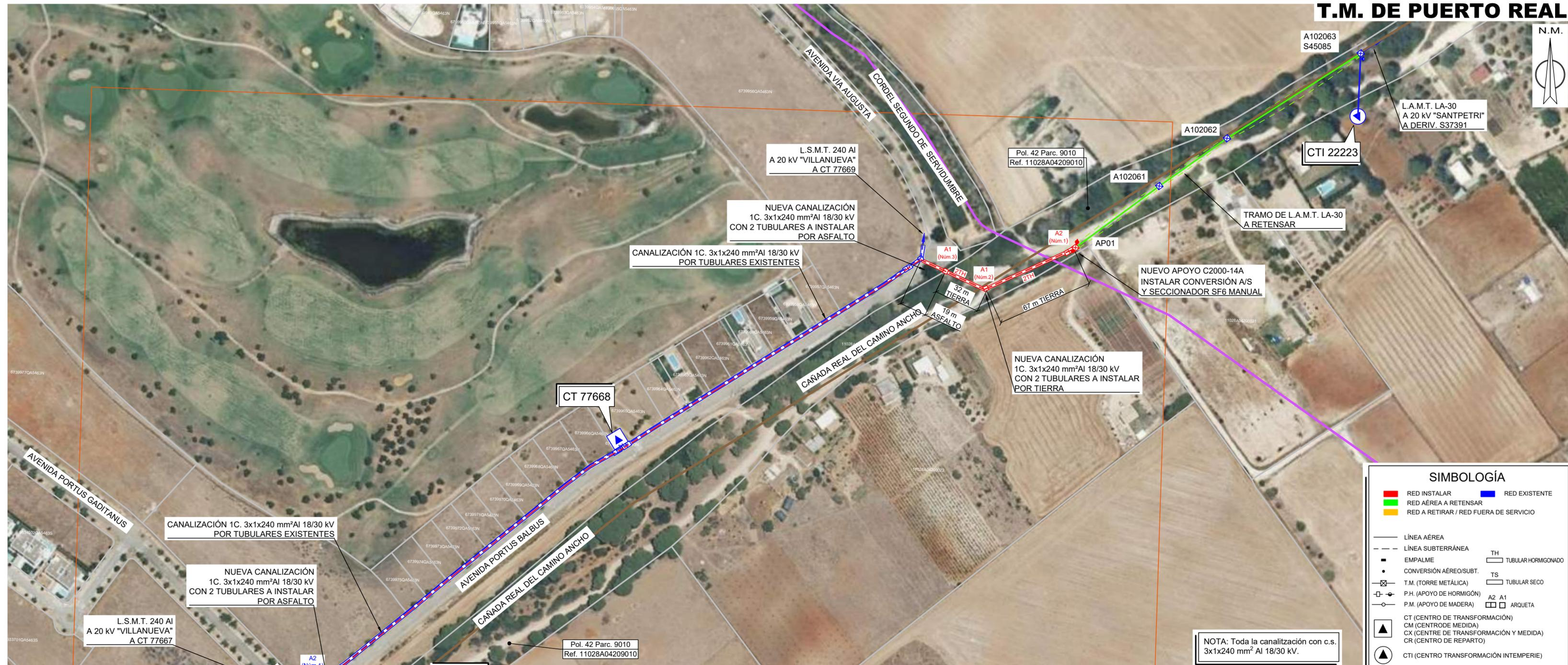
NOTA: Toda la canalización con c.s. 3x1x240 mm² AI 18/30 kV.
