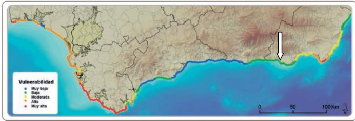
Figura 26. Representación simplificada de la asignación de la variable "altura media del oleaje significativo" a los tramos de 200 m en que se segmentó la costa andaluza. Fuente: Elaboración propia
