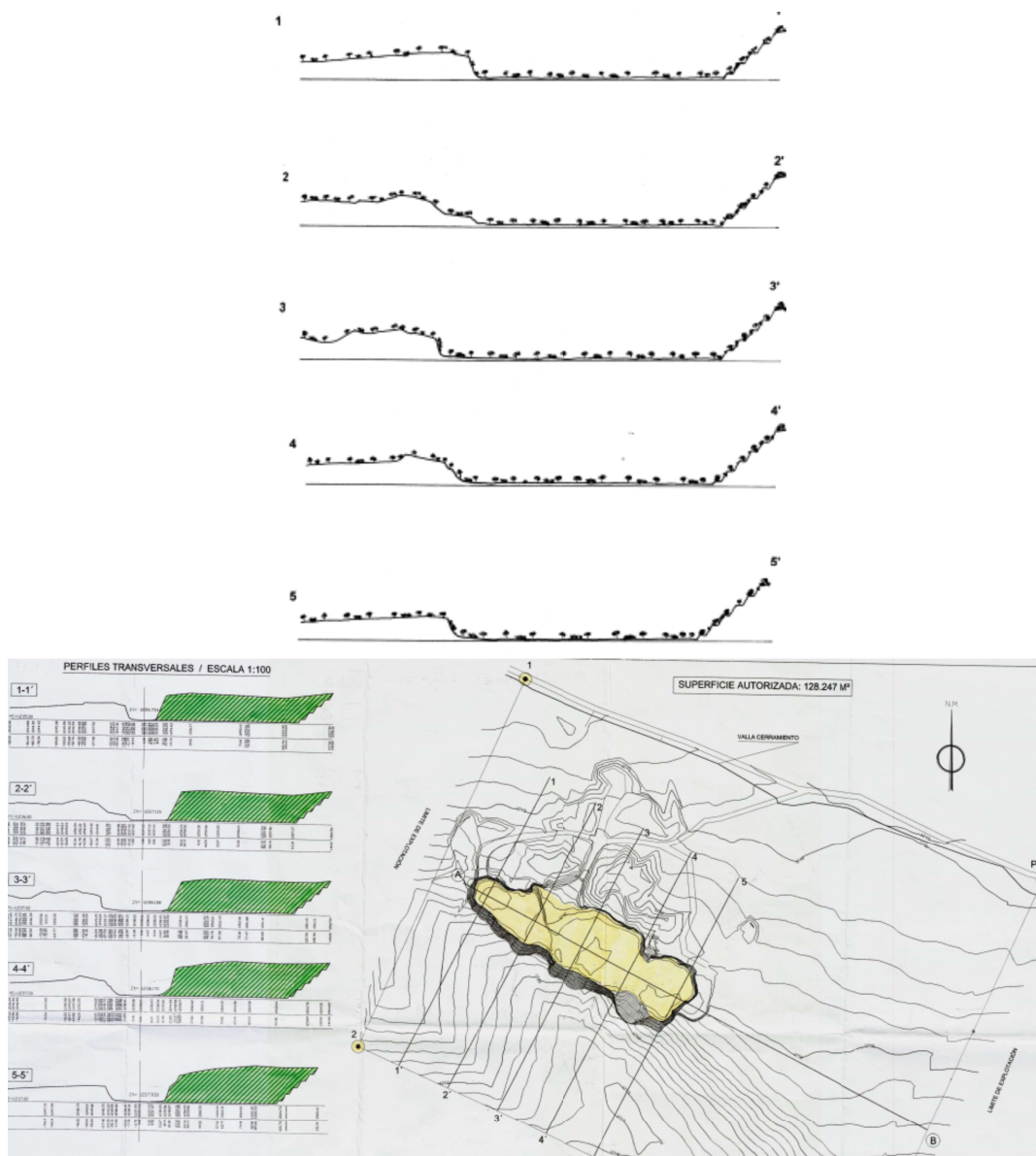
Figura 6. Restauración aprobada para el RSA) EL CHAPARRAL N.º 133.
