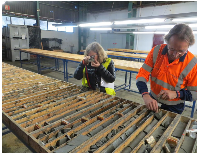
Fig.1. Comprobación de la testificación del sondeo nº MFF070 por parte de la técnica del IGME
