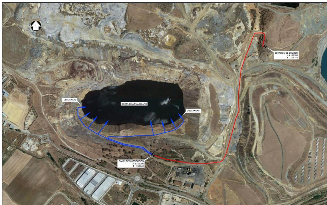
Figura 6.- Transporte y depósito de colas de proceso en el Pozo Aznalcóllar
