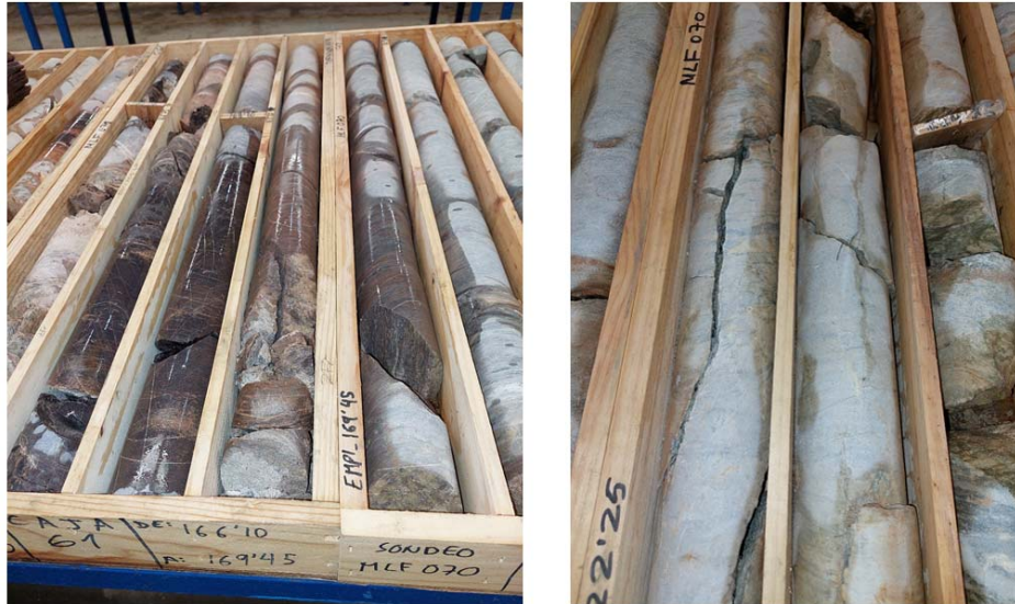
Cajas de testigos del sondeo MLF-070 expuestas en el almacén de sondeos.
