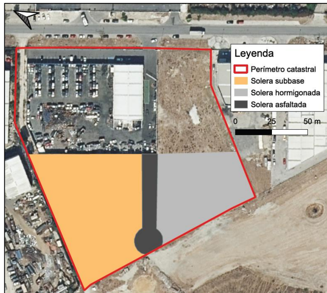
Figura 5. Detalle del estado final de las soleras. Fuente: Proyecto técnico de modificación sustancial de la autorización ambiental unificada.
