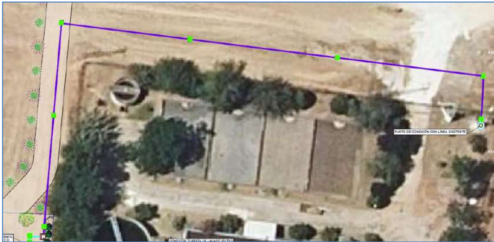
Figura 33. Línea eléctrica aérea de media tensión para suministro edificio tratamiento terciario
