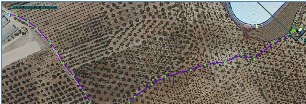
Figura 21. Línea eléctrica aérea de media tensión para suministro estación de bombeo red de riego
