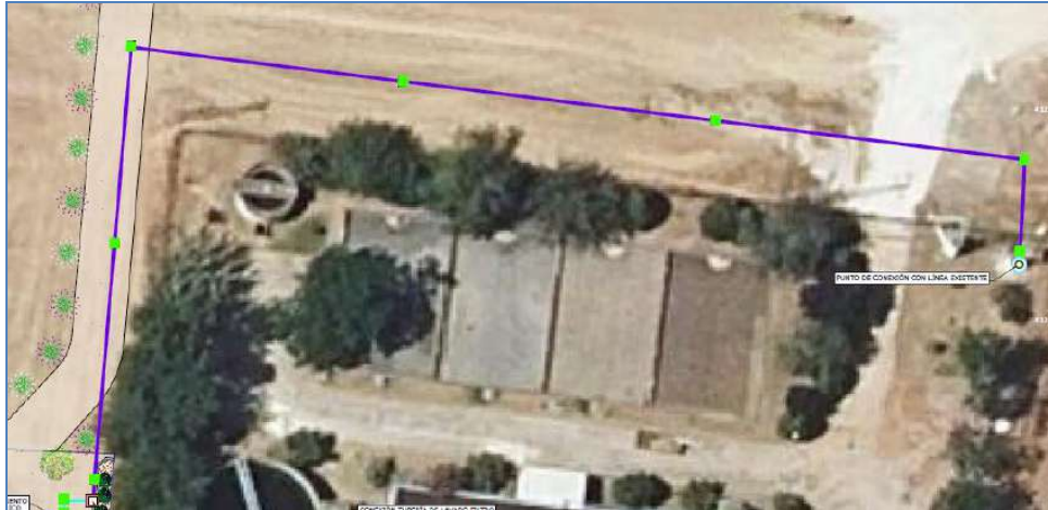
Figura 20. Línea eléctrica aérea de media tensión para suministro edificio tratamiento terciario
