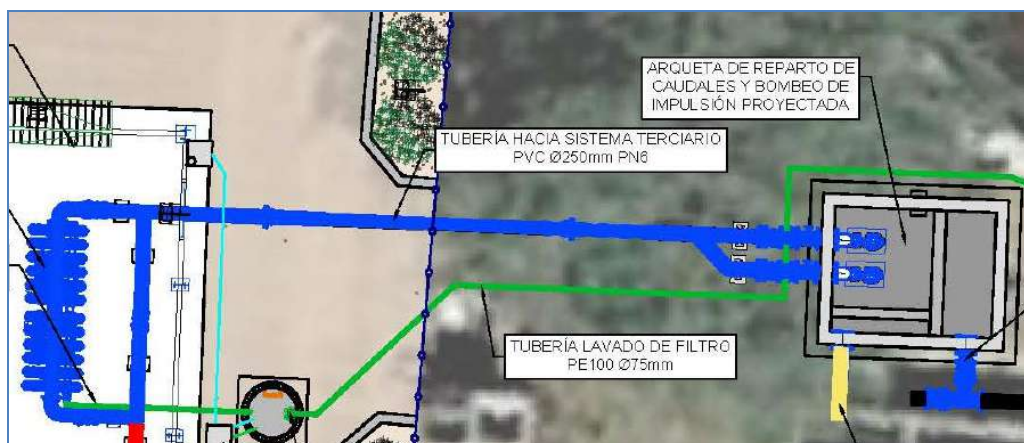
Figura 5. Conducción arqueta de reparto - edificio tratamiento terciario
