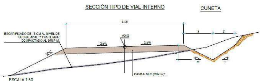
Ilustración 13: Sección tipo de vial interno.
