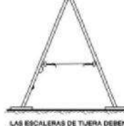
LAS ESCALERAS DE TIJERA DEBEN DISPONER DE CIERRE O CADENA Y DE ZAPATAS ANTIDESLIZANTES
