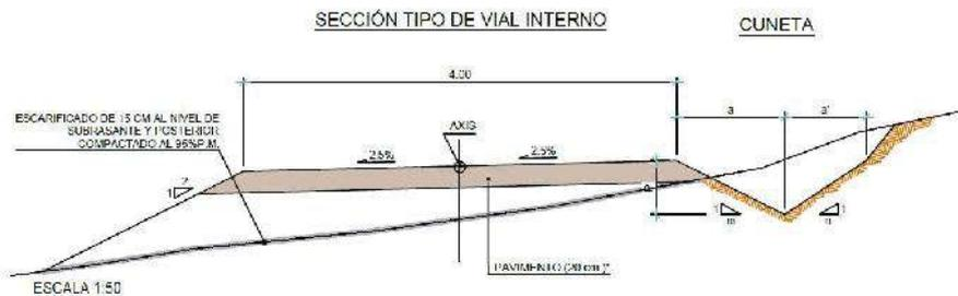
Ilustración 13: Sección tipo de vial interno.
