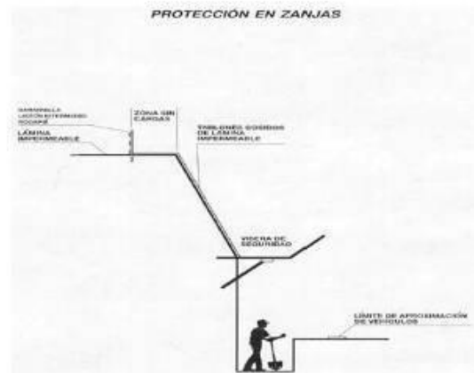
Figura 20: Protección, señalización y entibación de zanjas
