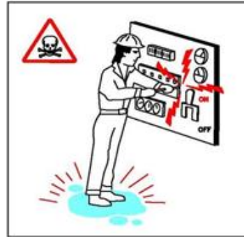
REPARACION DE EQUIPOS BAJO TENSION
