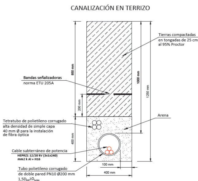
Ilustración 27. Zanjas asociada a una línea subterránea de evacuación
