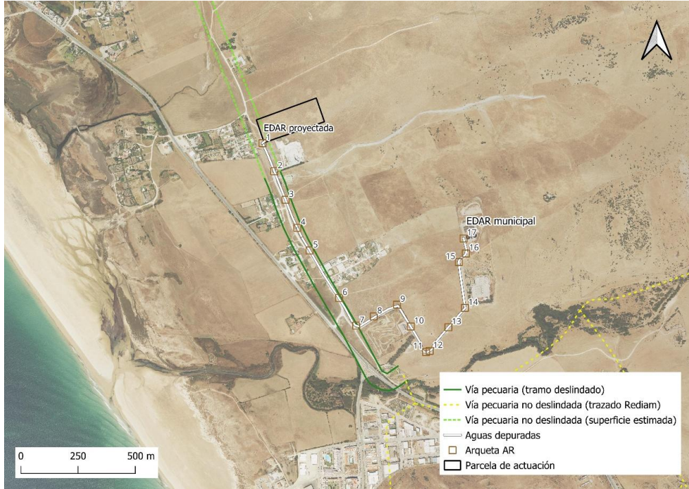
Figura 16. Canalización de aguas depuradas de EDAR proyectada a EDAR municipal en vía pecuaria.
