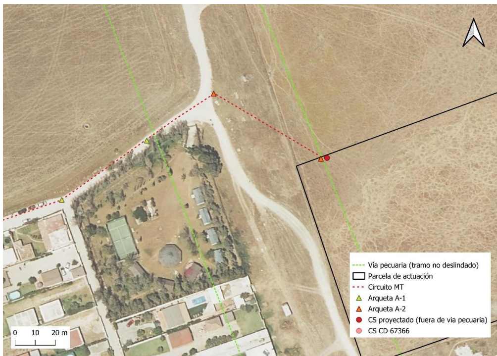
Figura 15. Detalle acometida eléctrica en vía pecuaria.
