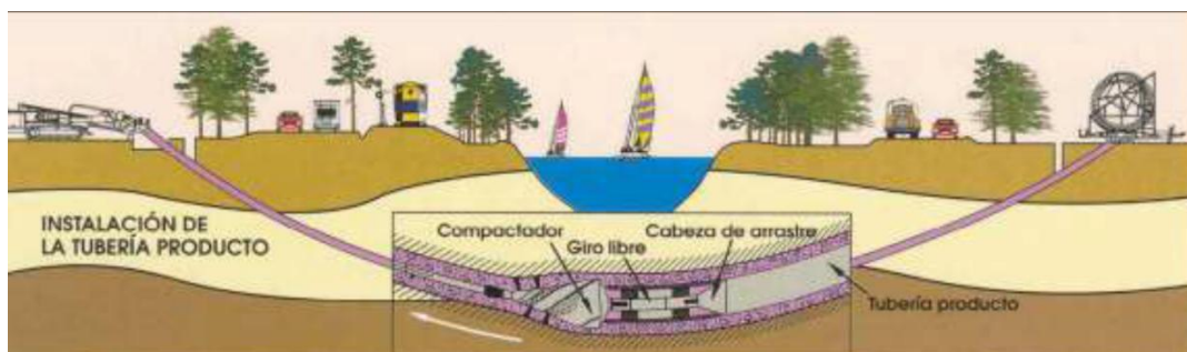
Figura 11 – Instalación de tubería
