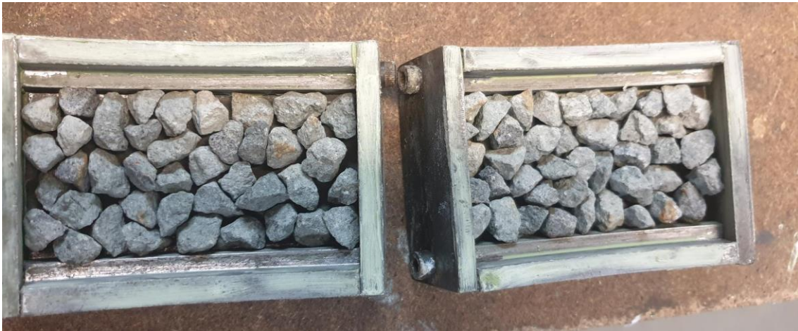
RUEDA 2- FABRICACION PROBETAS ÁRIDO
