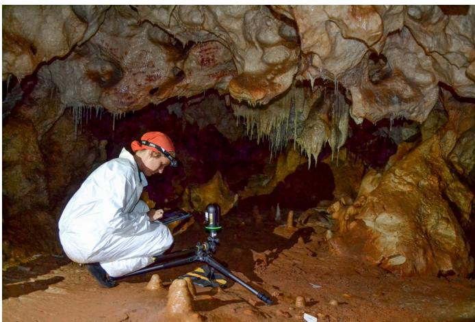
Fotografía durante el trabajo con láser escáner en la Sala de las Pinturas de Cueva Navarro. Autora: Eva Rodríguez (Universidad de Córdoba).
