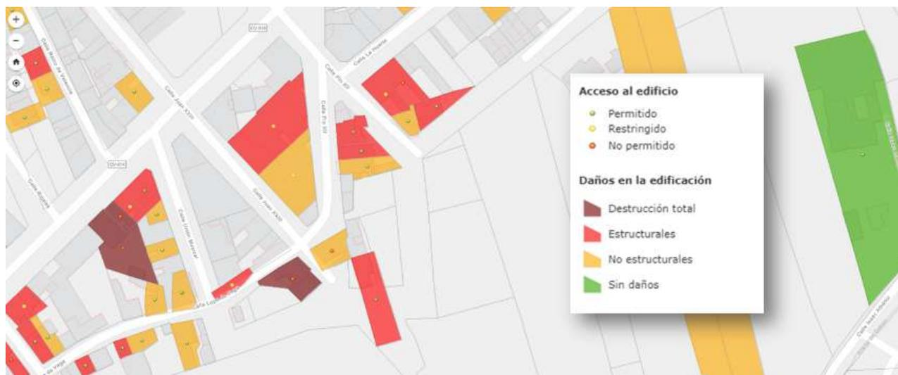
Fig. 4. Mapeado de los resultados de las inspecciones de edificios afectados por la DANA 2019.
