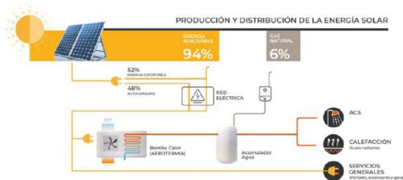
Fig. 3 Esquema de instalación propuesta. Estimación de consumos. Fuente: Construcciones Domeño
