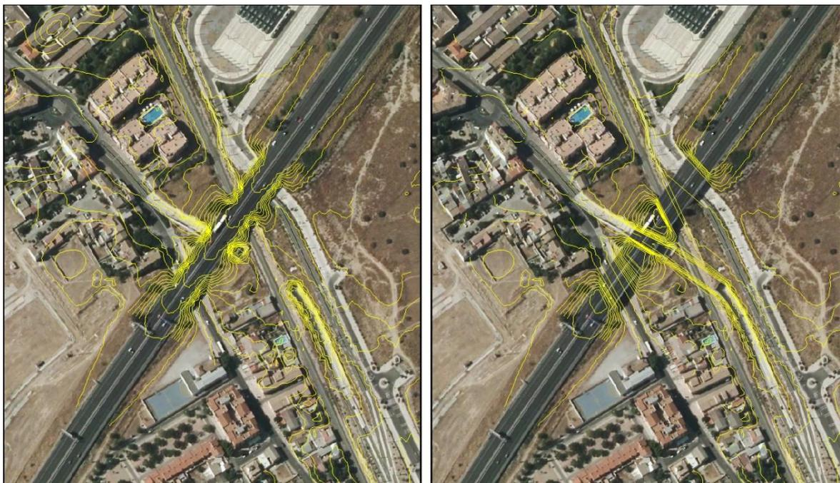
Figura 8. Corrección de un enlace en el MDT. Fuente: Elaboración propia.
