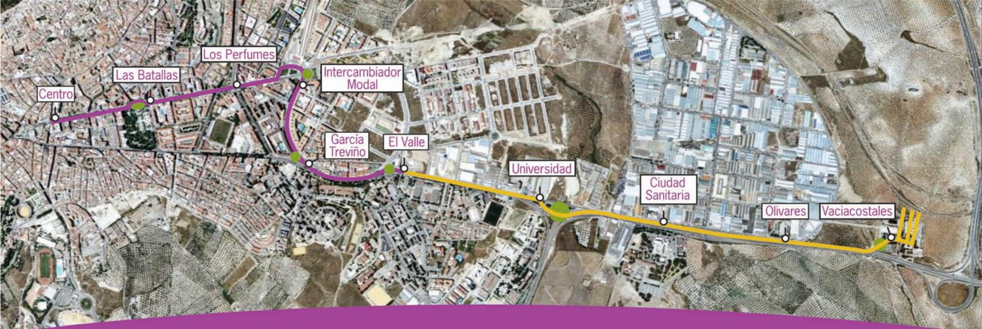
El trazado del Tranvía de Jaén, que consta de una longitud de 4,7 kilómetros y 10 paradas, se ha diseñado atendiendo, además de al criterio de la intermodalidad (con la estación de ferrocarriles y
