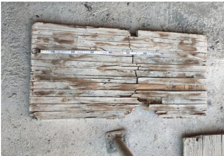
Unión de las dos partes en que se rompió el tablero causante del accidente.
