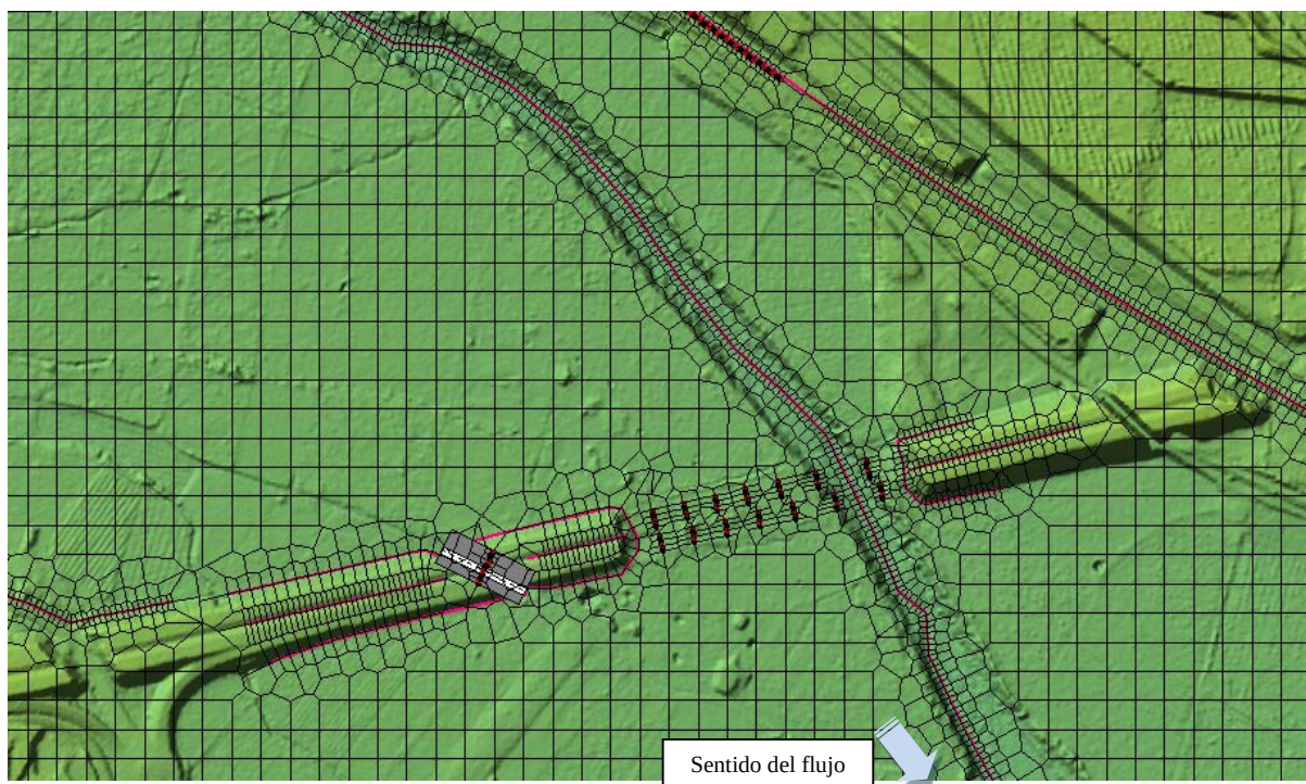
17 Mallado con detalle de los terraplenes, las pilas y la Obra de Drenaje Transversal del puente de la A-357, así como el cauce del río Guadalhorce y las vías del ferrocarril convencional.
