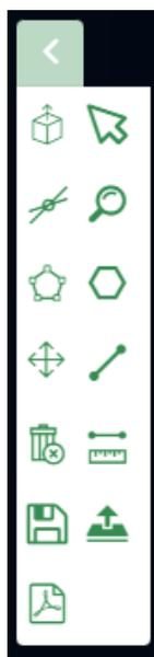
Algunos botones tienen un submenú que se despliega al situar el ratón sobre el botón. Éstos son los botones de : Seleccionar, Zoom, Dibujar , Operaciones de Conjunto y Medición (coinciden con las 5 primeras herramientas de la columna de la derecha).
